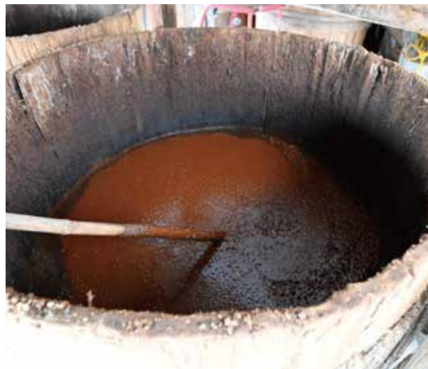
発酵していく醤油と対話しながらの仕込み工程。かき混ぜるタイミングや時間は職人の勘で決まります。
